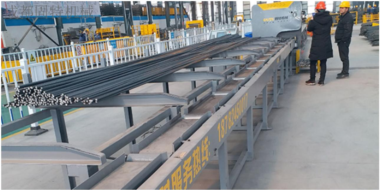
数控钢筋剪切线，钢筋棚施工越来越多客户开始选择的产品，和钢筋弯曲中心配合使用，是大批量剪切指定钢筋尺寸的利器。1、数控棒材钢筋剪切线（又名筋研智能数控钢筋剪切线，钢筋剪切生产线，全自动钢筋剪切线等）设备产品介绍：该机引进欧洲设计理念，经消化吸收并结合国内钢筋实际加工情况而研发的一种新型高效率钢筋剪切设备，用于棒材钢筋的切断。通过伺服电机驱动丝杠机构来调整剪切刀口与定位挡板之间的距离，采用编码器测量，定尺精度高，可达 $\pm 2\text{mm}$ 可剪切各种长度的钢筋。数控钢筋剪切生产线采用液压剪切方式，体积小、剪切力大、产量高，与一些厂家的机械冲剪方式相比，具有噪音低，使用寿命长，设备运行稳定等特点；与此同时数控棒材剪切线钢筋采用油缸压料，压力大，剪切时，钢筋不会转动，钢筋切头均匀。
